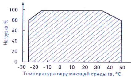
Рис. 2. Максимальная допустимая нагрузка, % от мощности источника.
